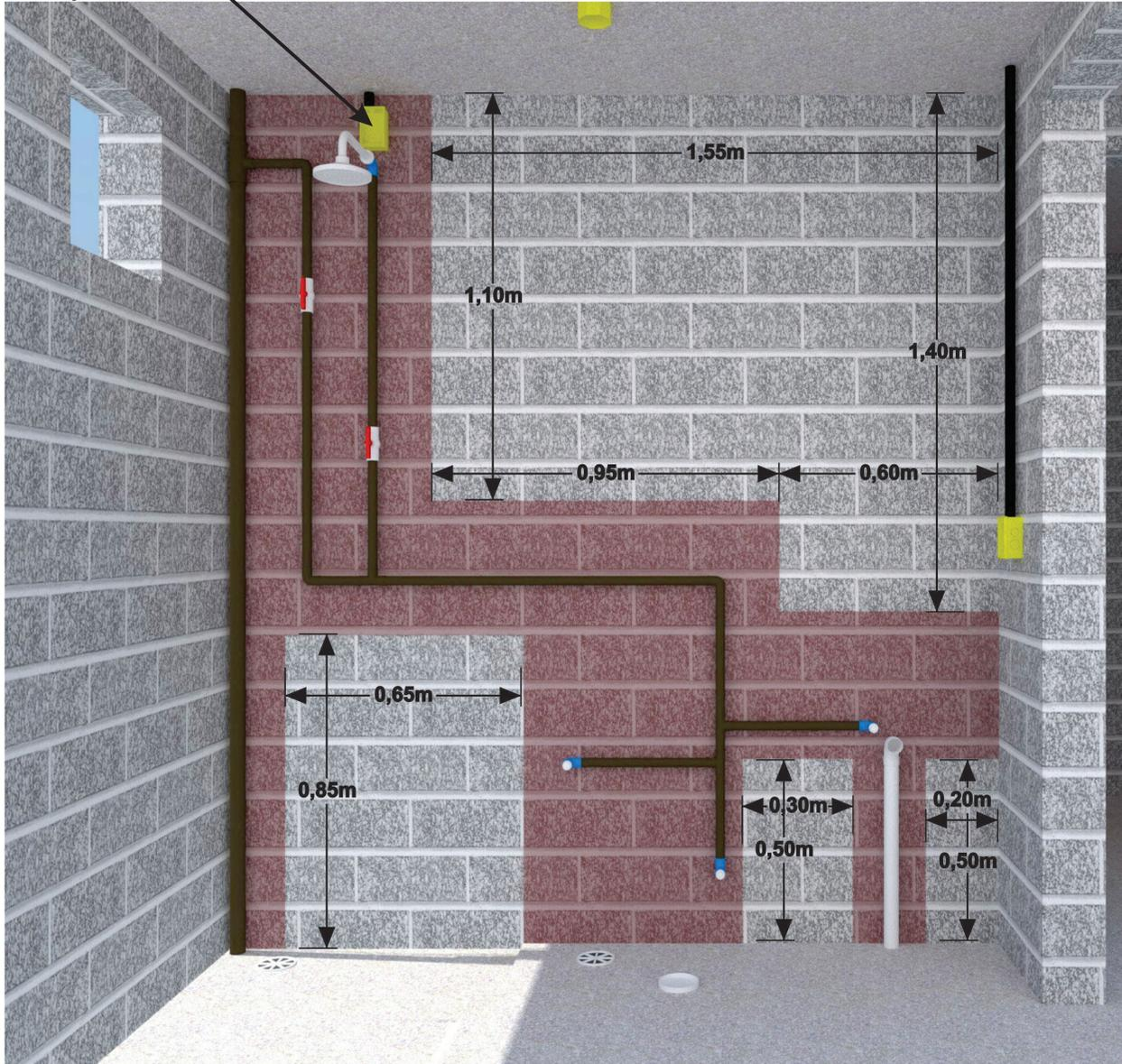
Esquema da instalação que fica embutida na parede
