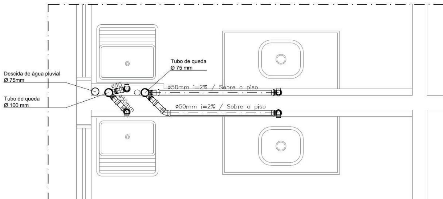
DETALHE DA INSTALAÇÃO DE ESGOTO DA COZINHA
